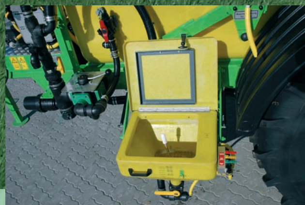
Posuda za ispiranje 60 l s dizom za ispiranje kanistera i kružnim vodom za pranje (rotirajućim)
