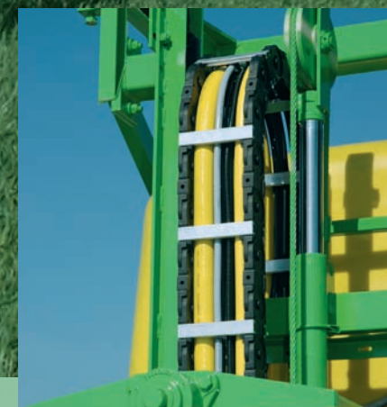
Centralno vođenje crijeva u podizaču pomoću lanca - vodilice.
