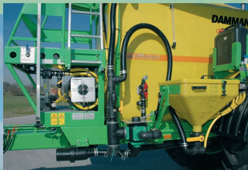
Pregledni instrumenti i instalacije. Jednostavno posluživanje preko centralnog ventila u usisnom i tlačnom području.
